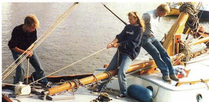
Mast hijsen met sprengel, Bremerhaven '89.
