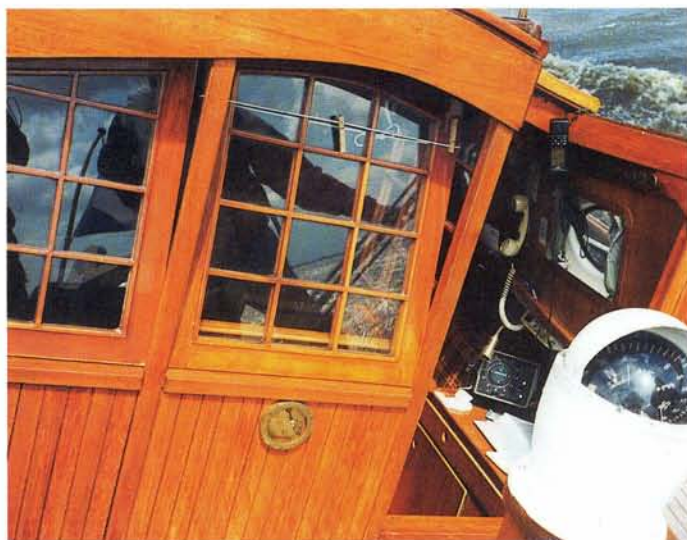
Goed zicht op alle navigatie- en hulpmiddelen: kompas, dieptemeter, hellingmeter, marifoon, opgehangen hand gps. De kaart zit normaliter onder het elastiek vast met knijper. Hij is verwijderd vanwege het spiegeleffect van het raampje.
