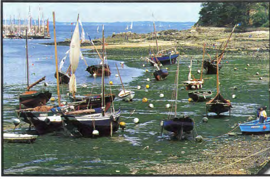
Bij laag water lig je in Douarnenez in een soort weiland. De Franse schepen zijn er op ingericht; aan weerszijden van het schip zijn stutten gemaakt zodat ze niet omvallen.
