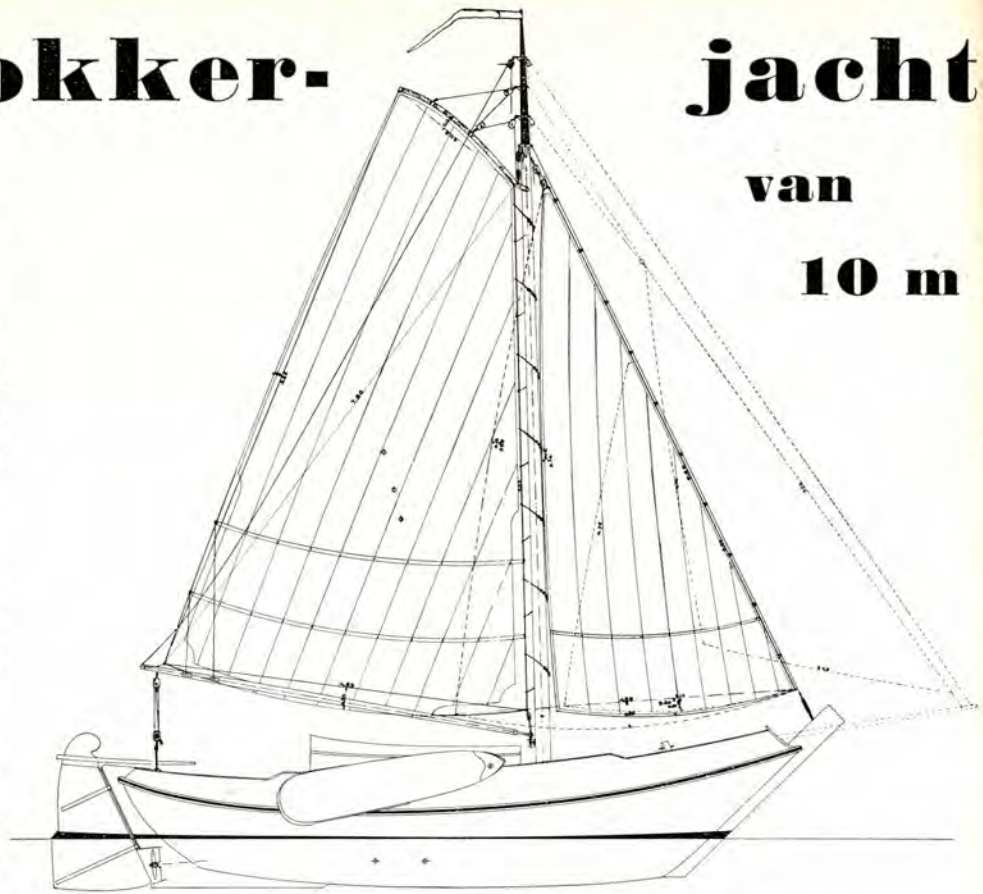
Schokkerjacht, ontwerp Ir. H. Vreedenburgh. Zeiltekening schaal 1:100. Zeiloppervlak 39 m 2 , grootzeil 26.50 m 2 , stagfok 12.50 m 2 , kluiver 8.50 m 2 , botterfok 17.50 m 2 , stormfok 7.30 m 2 .
