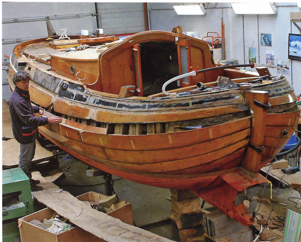
Het berghout is gesloopt.
