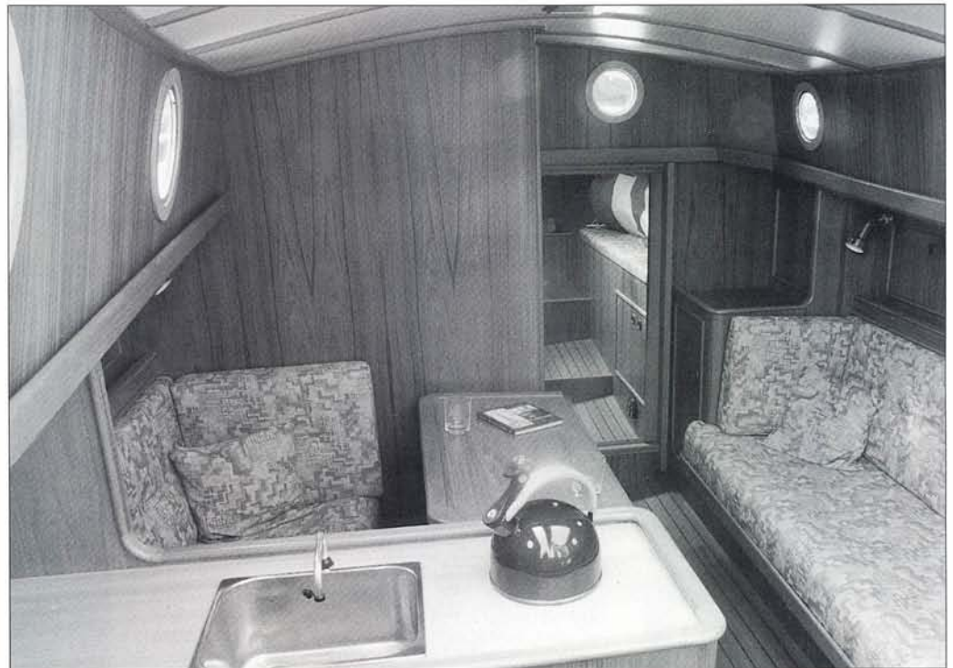
Interieur van de 8 meter Staverse jol. Hier is gekozen voor een ruime U-vormige kombuis en een korte zitbank met tafel aan bakboord. In de jol hierboven zeilend afgebeeld, is de kombuis L-vormig en zijn er twee lange zitbanken. In de kajuit is nog ruimte voor een navigatiehoek. Onder het voordek een ruime tweepersoonskooi en twee kooien boven elkaar aan sb. Veel ruimte in een scheepje van 8 meter!
