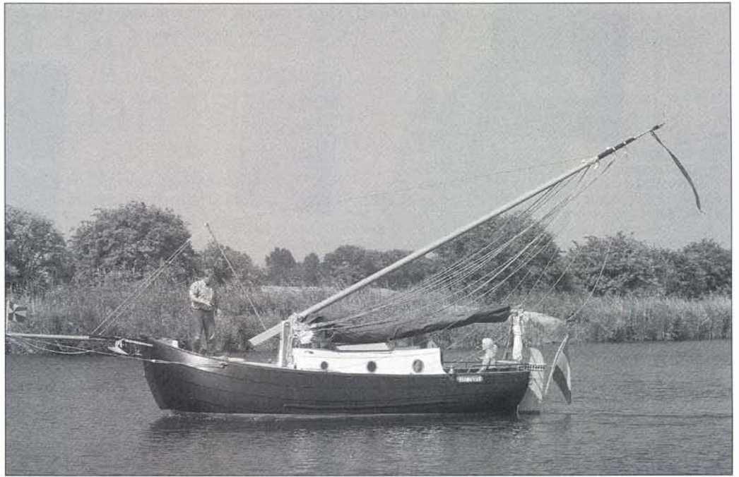
De mastvergrendelingsbout wordt verwijderd. Met een drukknopbediening kan het voorstag worden gevierd.
