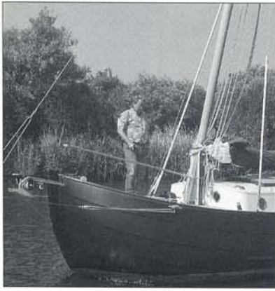
De mastvergrendelingsbout wordt verwijderd. Met een drukknopbediening kan het voorstag worden gevierd.
