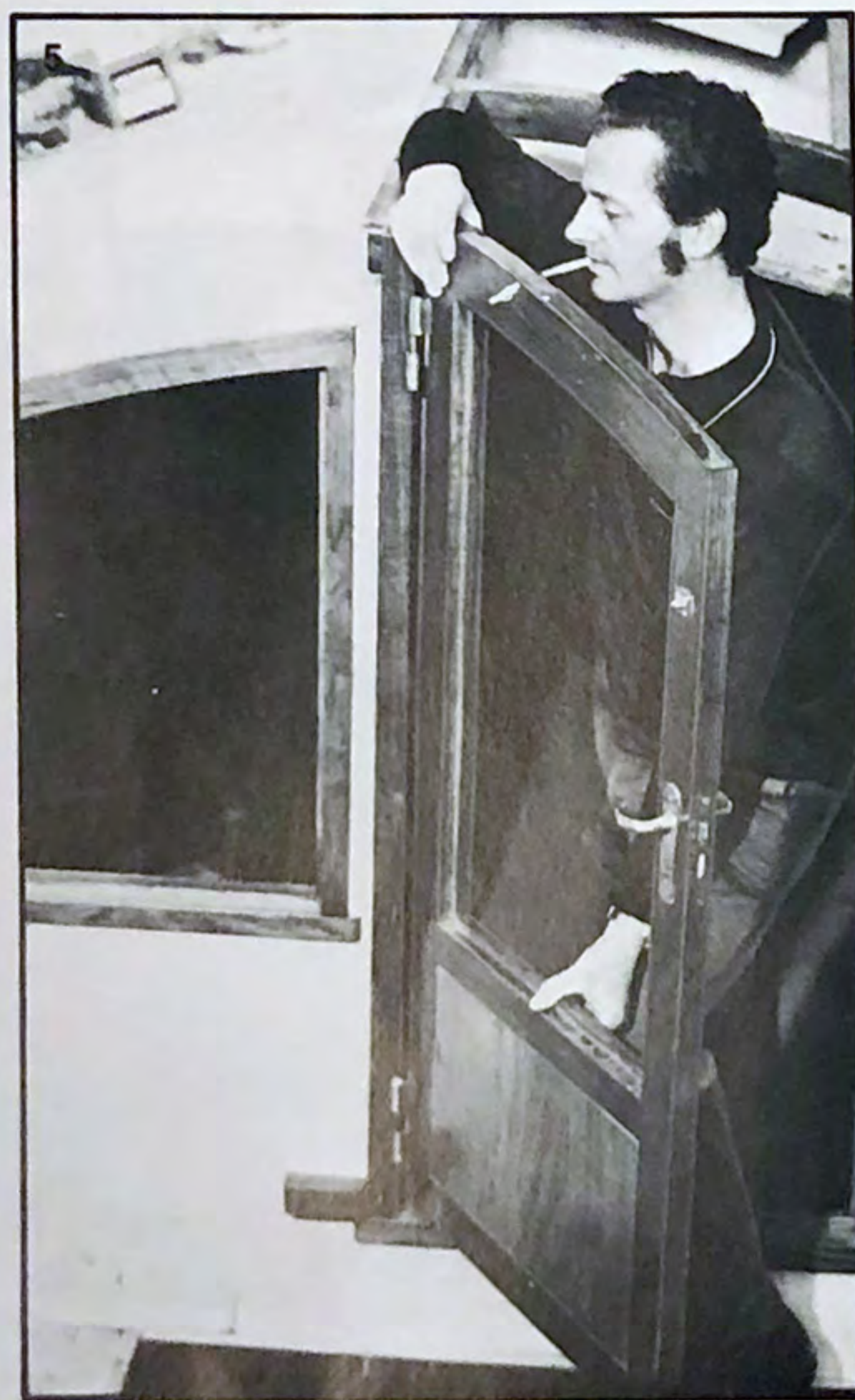
4. De jaloezie-latjes komen in de sleuven welke in de stijlen gemaakt zijn. 5. Nadat het deurbeslag — scharnieren, slot, deurkruk — is aangebracht, hangen we het deurtje in het kozijn.
