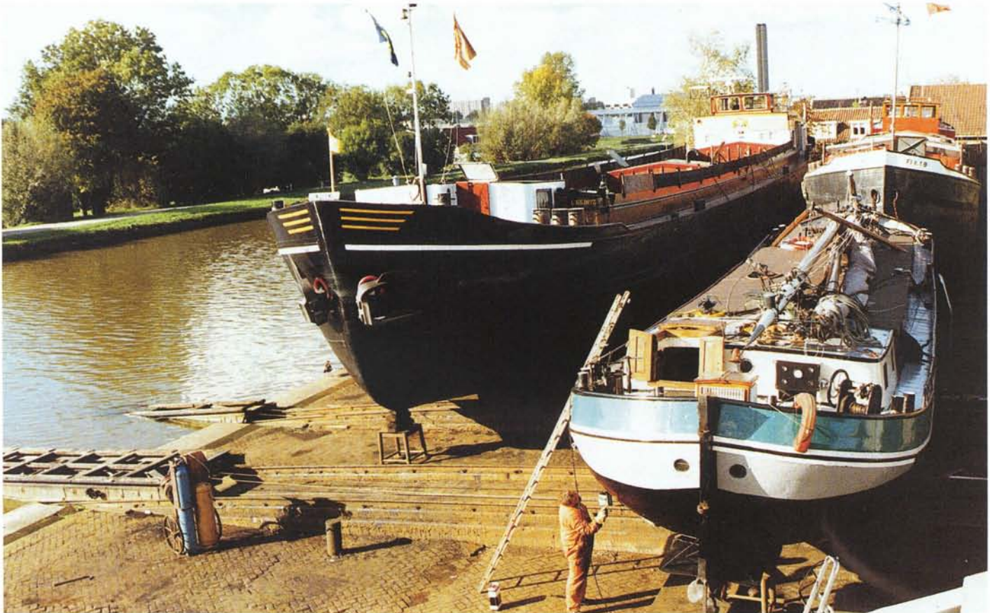
Het voordeel van een lange dwarselling is dat er meerdere schepen naast elkaar en achter elkaar omhoog kunnen worden gehaald.
