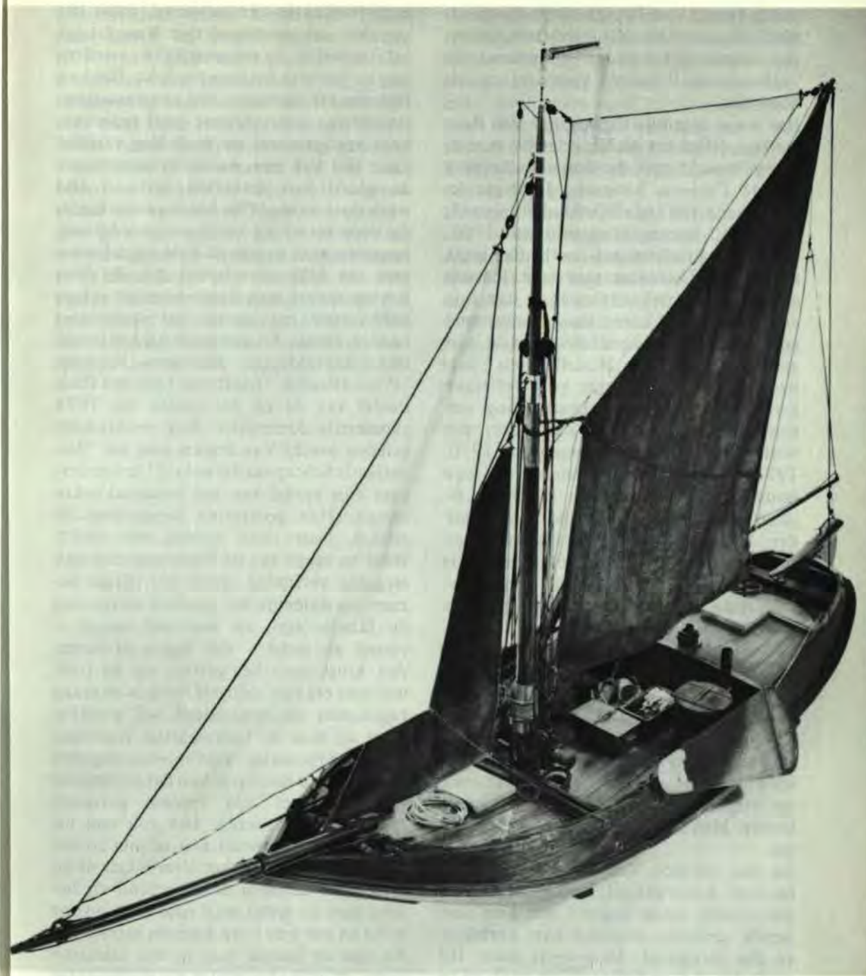
Model van een Arnemuider hoogaars, schaal 1:10, gebouwd door J. van Beylen naar tekeningen van zijn hand, die zijn gebaseerd op een origineel bestek uit 1874 van de werf Meerman te Arnemuiden. Maritiem Museum 'Prins Hendrik', Rotterdam
