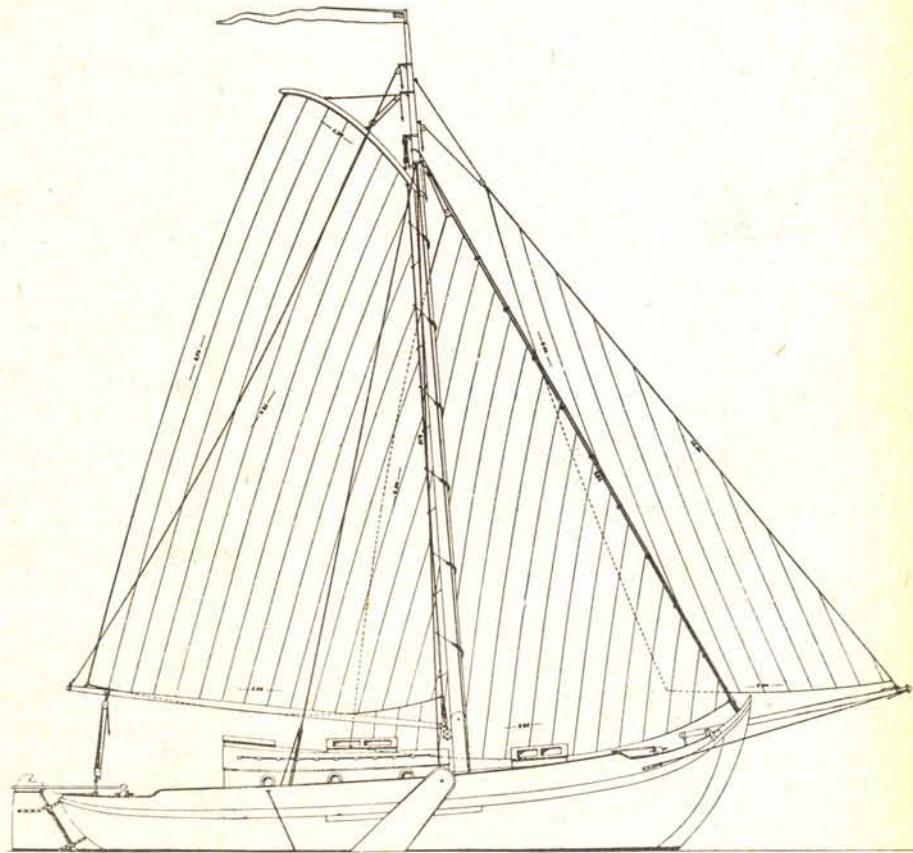
Zeilplan van het 11 m lange botterjacht. Grootzeil 36.2 m 2 , fok 27.5 m 2 , kluiver 15.1 m 2 , totaal 78.8 m 2
