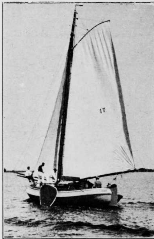
„Kampioen.“ Stalen Boeier met tuig volgens het door de verbonden Zeilverenigingen vastgestelde type 1900.
