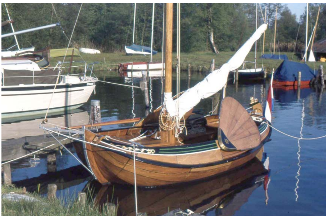
Dia GtC 1979. Het kleinste Friese jacht met een lengte over de stevens van 4,56 meter, gebouwd door Lantinga uit IJlst in 1902. Duidelijk te herkennen zijn het berghout, het vergulde snijwerk aan de buitenkant op het boeisel, het bakboord kluisbord met beretand, gepoetst koperwerk en de vergulde leeuw op het roer.
