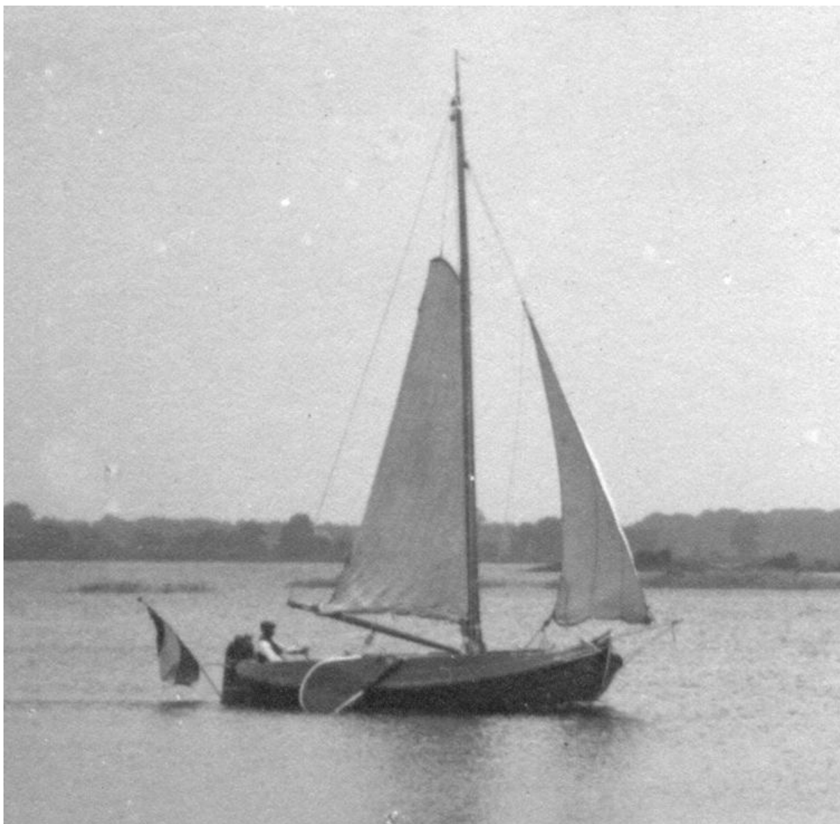
foto Kramer 1915 scan.GTC uitsnede uit oorspronkelijke tweelingfoto (coll. Levert) Het lijkt alsof het boeisel ter hoogte van het voordek verhoogd is.
