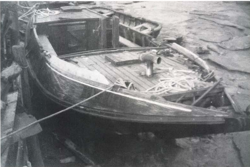
Aan de werf bij De Klerk. Nieuwe zetboorden zijn al geïnstalleerd.
