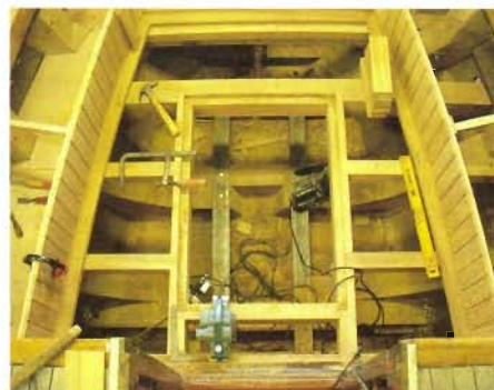
Het achterschip is vernieuwd en de dekbalken voor de kuipvloer zijn aangebracht.
