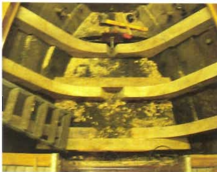
Het achterschip is vernieuwd en de dekbalken voor de kuipvloer zijn aangebracht.
