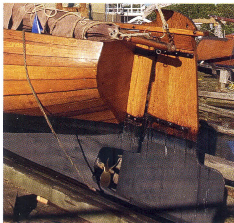
Staverse jol HL 90, in 2016 in Workum gerestaureerd door Ivor van Klink. Hij voorzag het roerblad van een 'balans', waardoor de jol beter stuurt
