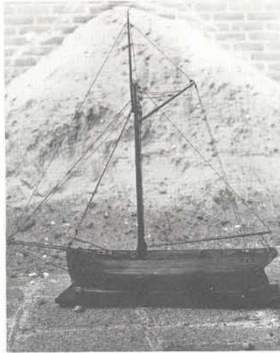
Op spanten gebouwd, palmhouten model van een zeilsloop. Ontworpen en gebouwd naar F. N. van Loon. (Fries Scheepvaartmuseum te Sneek)
