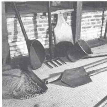
Turfmakersgereedschap voor de baggerfase: baggerbeugel en spittersschop; poepenjut, klauw en gieremmer. (Provinciaal Museum Zwolle)
