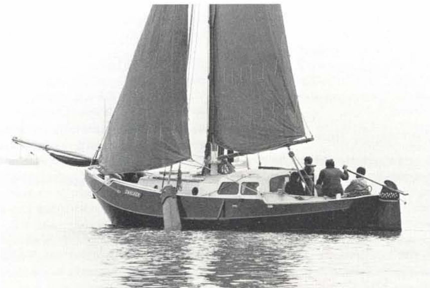
Zeeschouw Thresoor, ontwerp J. Kok. L.o.a. 10 m, l.w.l. 8.20 m, b. 3.47 m, d. 0.80 m. Schaal 1:90
