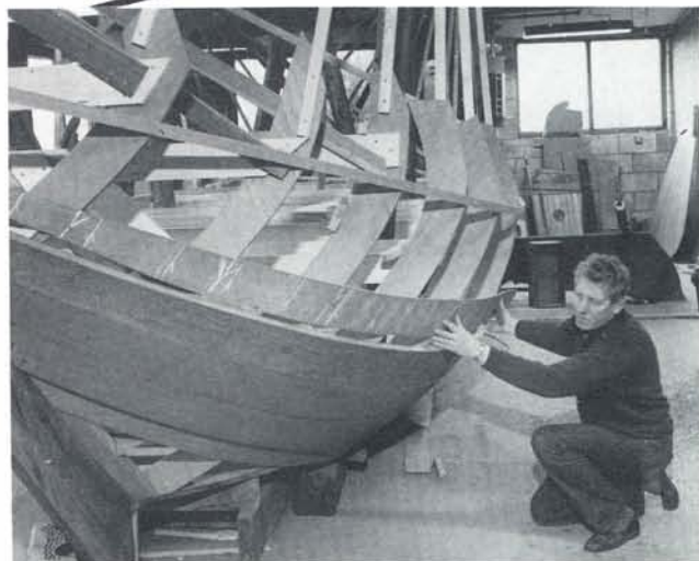
Joh. v.d. Meulen brengt een mal aan tegen de bouwspanten.
