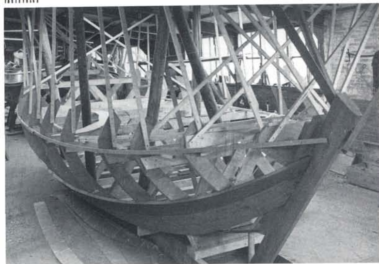
Voor- en achterschip van de pluut. Zware schoren houden het vlak in de juiste kromming. De bouwspanten worden nadat de huid is aangebracht vervangen door zware spanten.
