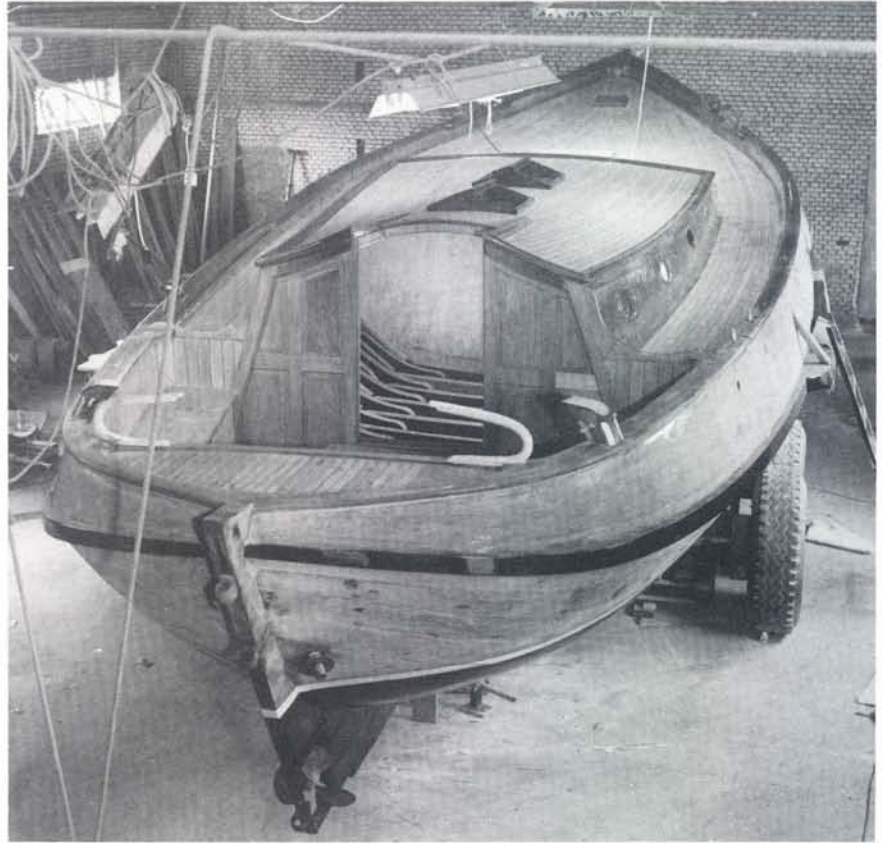
Het middenzaathout heeft een verloop in de motorfundatie.
