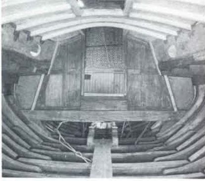
Het middenzaathout heeft een verloop in de motorfundatie.
