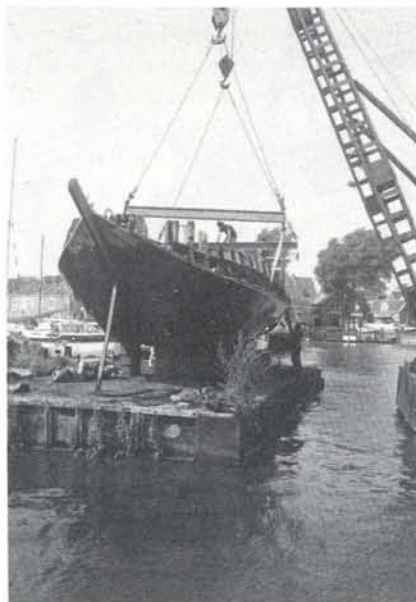
Een van de spannendste momenten, de tewaterlating. De hoogaars gaat in de takels bij scheepswerf de Rietpol. Twintig ton eikehout wordt van de ponton getild en na het stukzweepen van een in aluminiumfolie verpakte fles Spa teruggelegd in het natte element. Het schip blijft droog, een staaltje van degelijk breeuwen.
