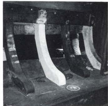
10 maart 1990. Het interieur van de kajuit wordt verruimd door het afbreken van het keukenblok en de kastjes. Hierdoor werden de motor en de dekenpootjes aan bakboord goed bereikbaar en kon er doorgewerkt worden die dag.
