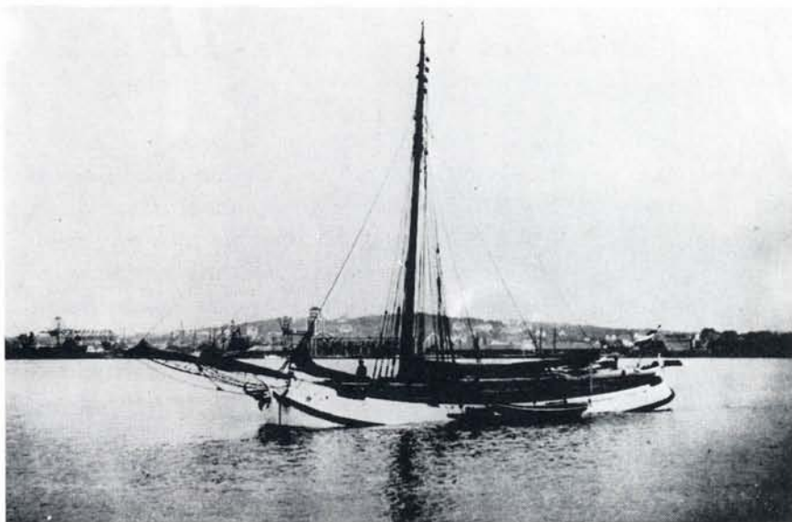
Afb. 31. Eénmastkoftjalk met deklasthout.
