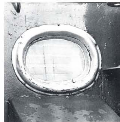
Afb. 28a en b. Roef van een zeetjalk met Kompasraam
