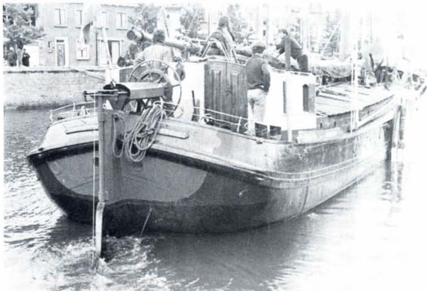
Afb. 30. Kleine Groninger tjalk met Engels stuurwerk
