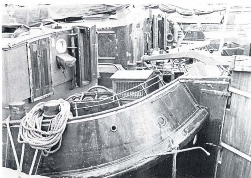
Afb. 28a en b. Roef van een zeetjalk met Kompasraam
