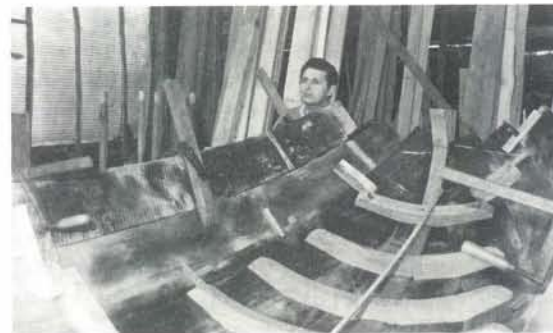
De boot staat in zijn huid tot aan het berg-hout. De vragan zijn geplaatst. De koppen van de achterste boorden zijn nog niet afgezaagd. Foto's Joris Dankaers.
