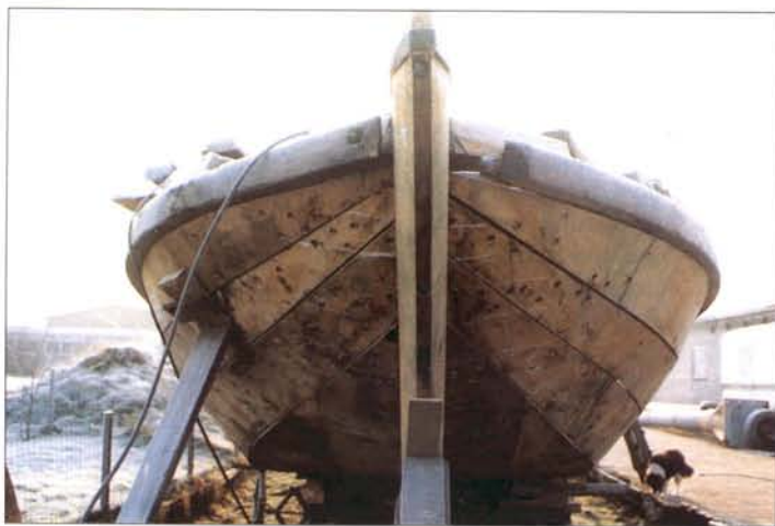
Het achterschip is nu geheel vernieuwd, ook de achtersteven is geplaatst
