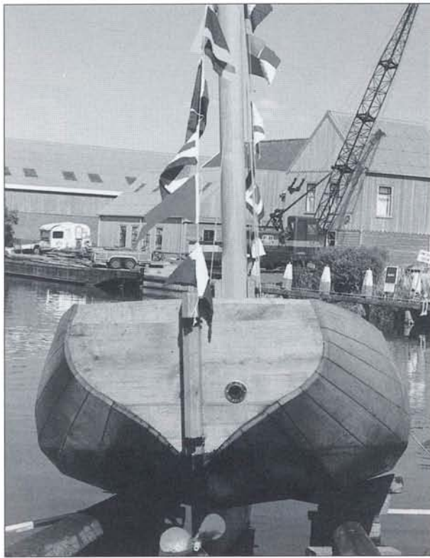
Kenmerken van Wildschut: wijn-glasvormige spiegel en licht gepiekt vlak.
