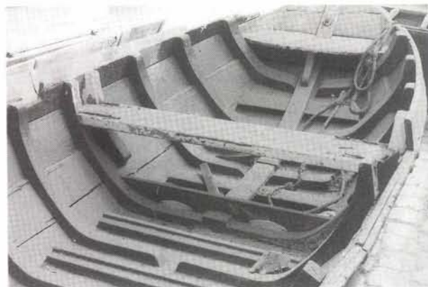
Zicht op de leggers en knieën, alsmede de overnaads liggende boorden van het Zeelandse type. Collectie Nationaal Scheepvaartmuseum Antwerpen. Foto: M. Kaak
