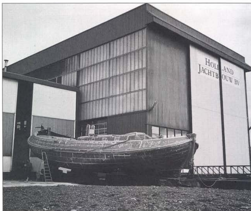
Het casco van een 16,5 m Lemste- raak, klaar om geschilderd te wor- den.
