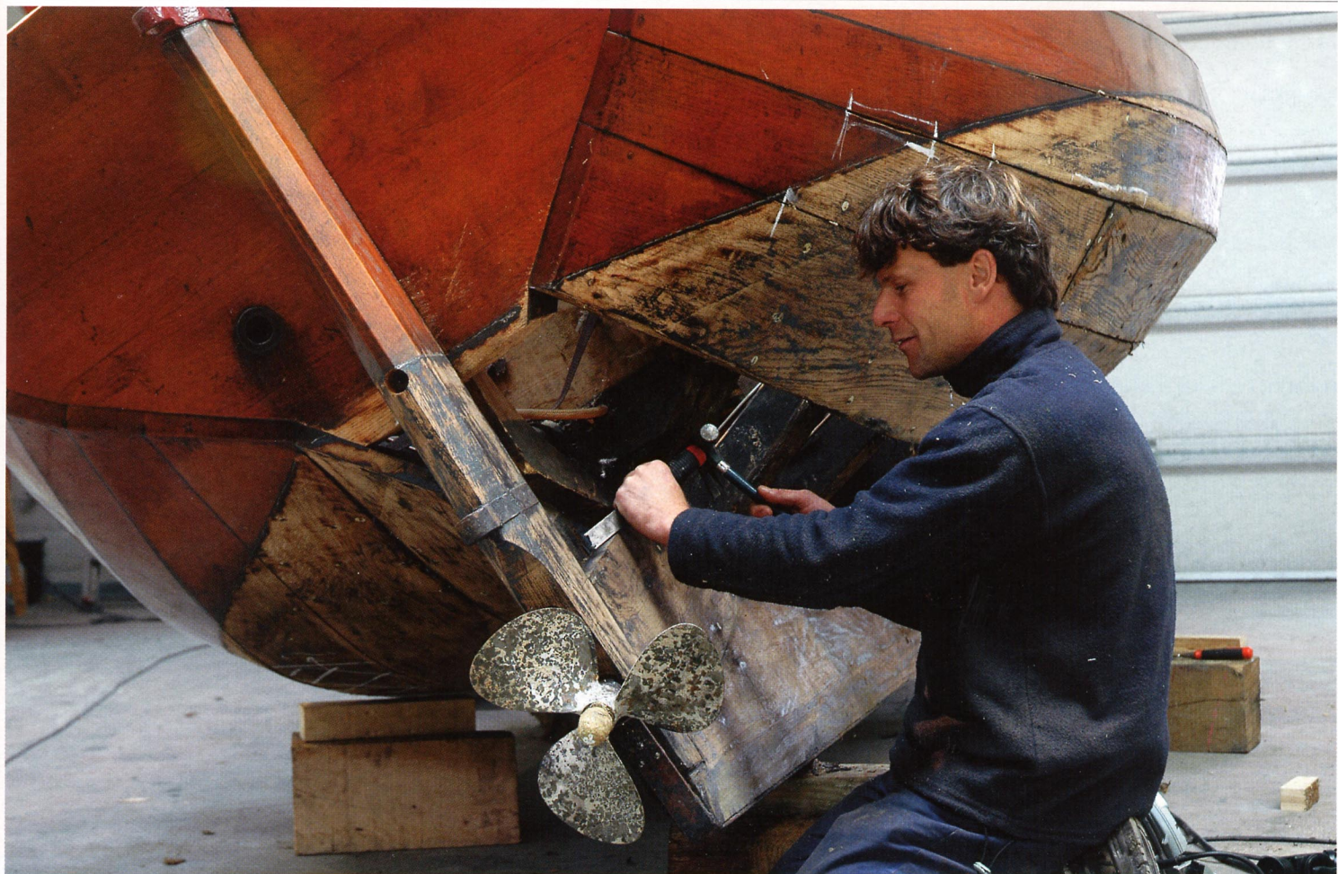
Deze Staverse jol krijgt een nieuwe vlakgang en een nieuw stuk doodhout. Onder: Nieuw zeilwerk voor de Jaega. De mastbank valt met kepen in de zeilspanten.
