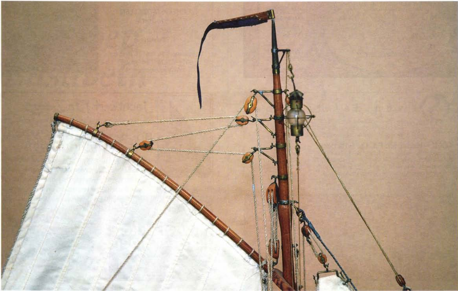
Details van de masttop met alle blokken en vallen. Ook de rondschijnende bollantaarn is niet vergeten. Bij de botters hing deze lantaarn aan een beugel op de voorsteven, maar de hoogaarzen voerden hem in de masttop.
