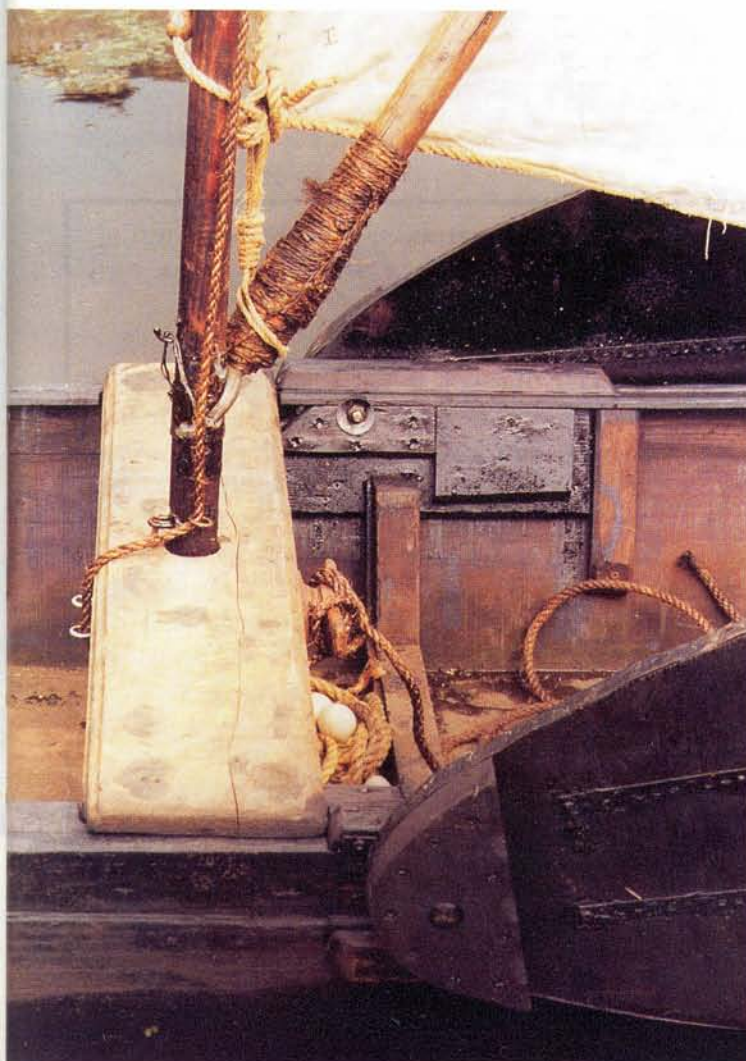
De constructie van de mastdoft. Goed is te zien hoe de spriet met aangebindselde roeidol aan het ijzerdraadje hangt. Het boord is bij de zwaardjes versterkt.
