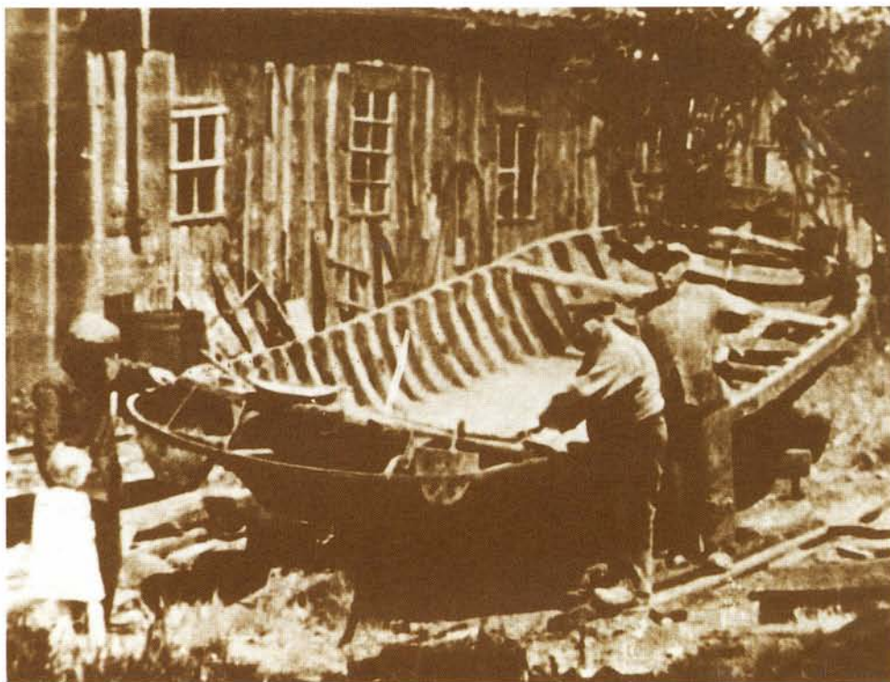
Gêrspream op de helling in Veenwoudsterwal. Let op, aan het achterschip is een grote, ronde, ijzeren beugel vastgemaakt ter bescherming van de buitenboordmotor.
