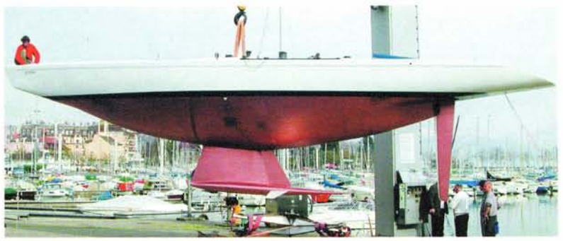
Nieuwe vleugelkiel en roer voor YQUEM, een International 8 Meter, die dit jaar de Atlantic Cup won en een tweede plaats veroverde bij de wereldkampioenschappen (ontwerp Piet van Oossanen).
