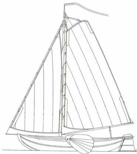
Reconstructietekening van het zeiltuig van een Friese handelaarsschouw, zeiloppervlak 13,5 + 7,5 m 2
