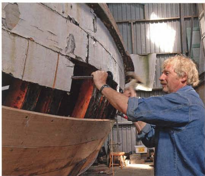
Rinse hakt de gangen stukje voor stukje weg, nadat hij ze heeft ingezaagd. Ze blijken van mahonie en niet van het oorspronkelijke eikenhout.
