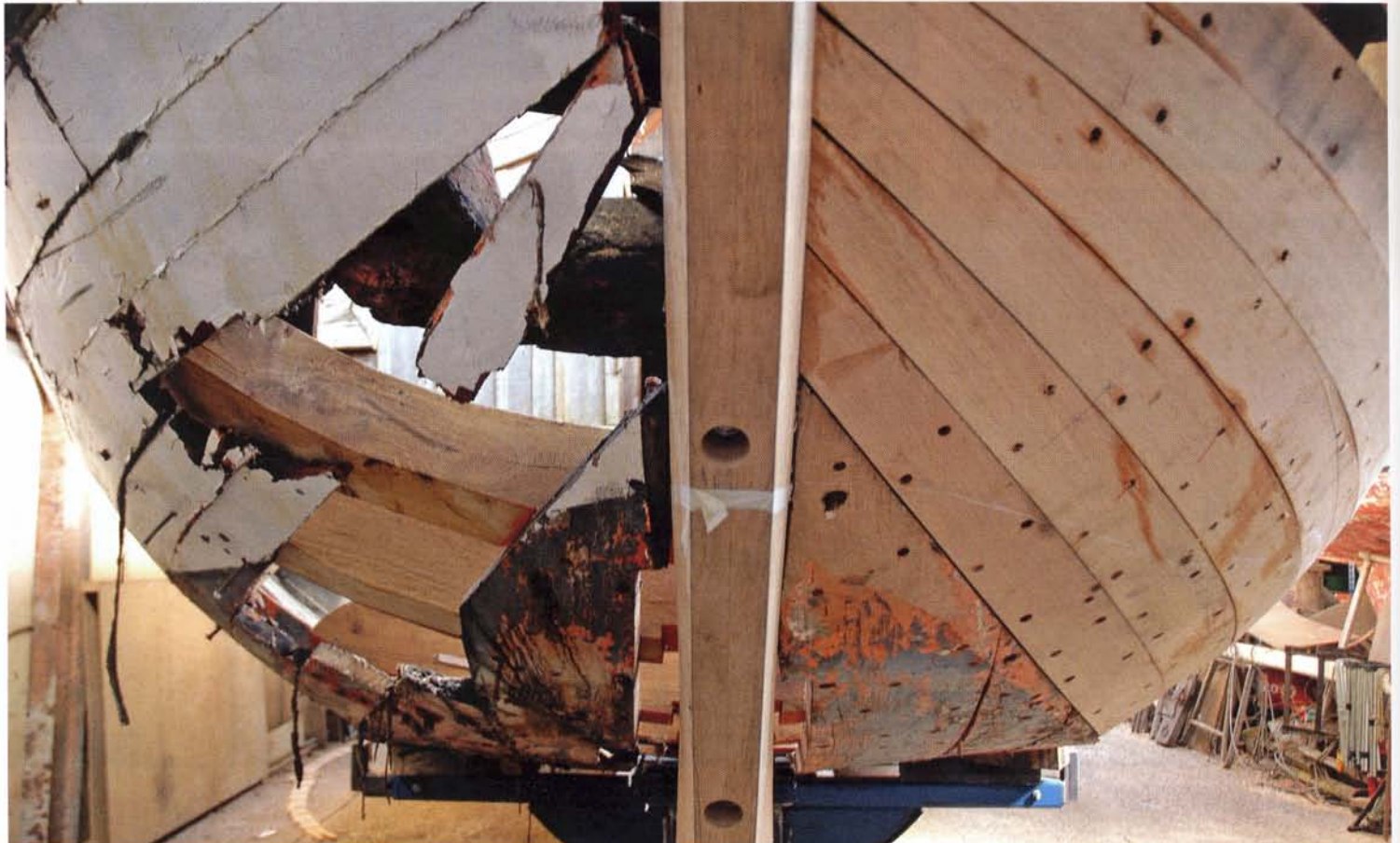
De jachtbotter is veel lichter gebouwd dan de oude vissersjibotters. Alle spanten, inhouten en liggers moeten worden vernieuwd, evenals het zeilwerk. Onder: Het achterschip aan stuurboord is al nieuw, evenals de achtersteven, nu nog de gangen aan bakboord.
