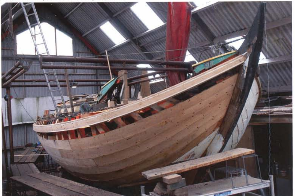
Zes gangen aan stuurboord zijn vernieuwd. Nu nog de laatste gang, het berghout en het boeisel. Onder: Duidelijk is de mooie zeeglijn te zien.
