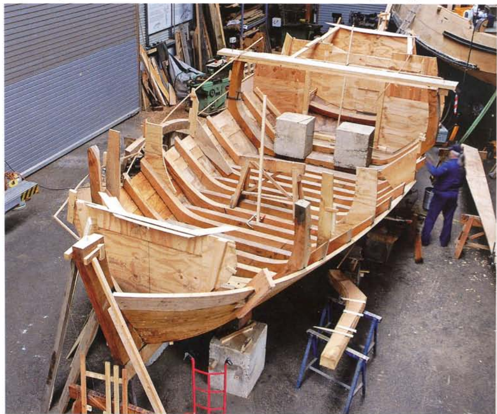
De nieuwe Pegasus in aanbouw. De blokken beton staan op het vlak om voldoende doorbuiging te krijgen.
