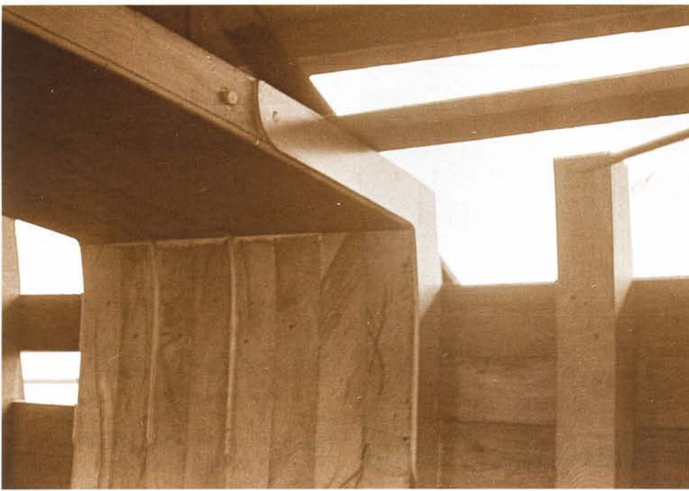
Melis van Duivendijk schuwde het experiment niet. Hier zien we de hoek tussen spanten en mastdoft. Die hoek is versterkt met gegalvaniseerd stalen platen tussen de eiken delen. 30-12-1933
