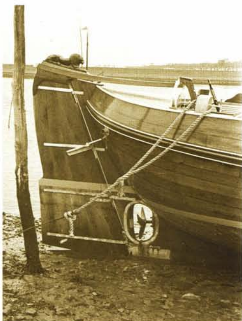
Het roer met het schroefgat en de "Engelsche" overbrenging naar het roer. Wat een prachtige leeuw, een kruising tussen een echte leeuw en een baviaan met oosterse trekken. Het schip is onder water nog niet afgewerkt. Er zit alleen een laag carbolineum op volgens de papieren. 3-10-1934
