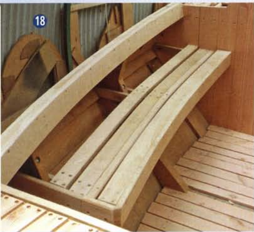
13 Het dek wordt gelegd met uitsparingen voor luik en dekprisma.
