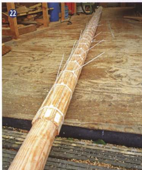
De achtkantige holle mast is in elkaar gelijmd met 2-componenten lijm. Top en mastvoet zijn gevuld.
