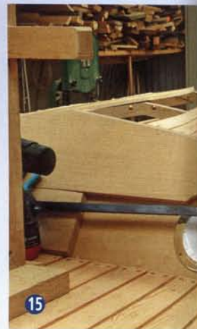
15 De kajuitopbouw wordt, net als Douglas spar gedicht.
