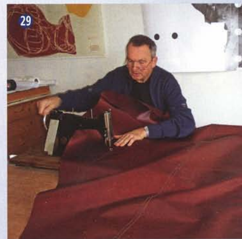
Het naaien van de zeilen is leuk werk voor koude winterdagen. Met een oerdegelijke Pfaff trapnaaimachine en door de zeilmaker gesneden banen (en instructies) zijn kleine zeilen door een amateur zelf te maken.
