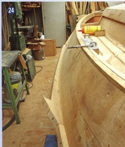
24 Bevestigingsogen en strijklamp voor het zwaard.
