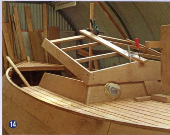
14 Kajuitopbouw met frame van opklapbaar dak.
