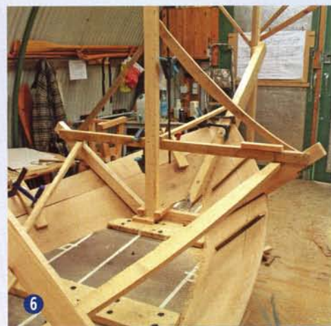
6 De onderste gang, opgebouwd uit twee delen op elkaar, is aan de voorsteven bevestigd.
