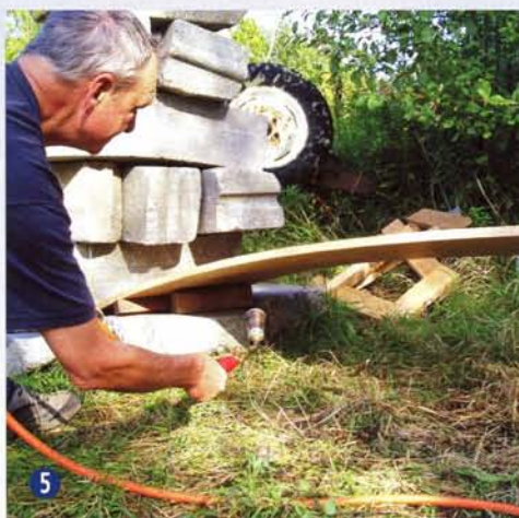
5 Met een gasbrander wordt het hout heet gestookt om het te kunnen buigen.
