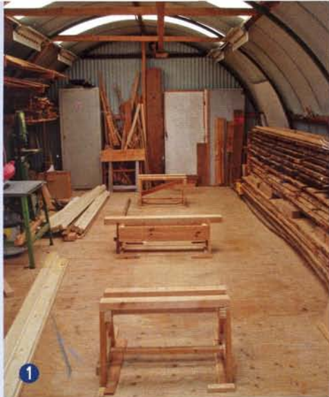
1 De bouwopstelling. Op deze drie bokken wordt het vlak gebouwd. De middelste is 10 cm lager dan de dan de andere. Rechts de voorraad eiken.
