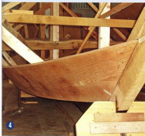
4 Het onderste deel van de eerste gang is bevestigd in de sponning van de voorsteven. De onderste gang is vanwege de enorme breedte (tot 40 cm) horizontaal in tweeën gedeeld.
