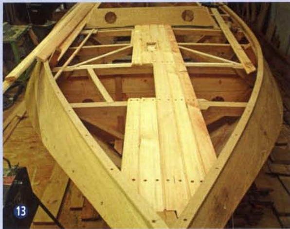
13 Het dek wordt gelegd met uitsparingen voor luik en dekprisma.
