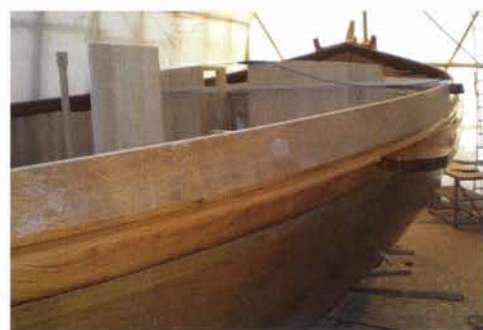
boven: De derde laag wordt gelijmd, nu volgt het berghout (onder), ook de gelamineerde zwaardklampen zijn al aangebracht
