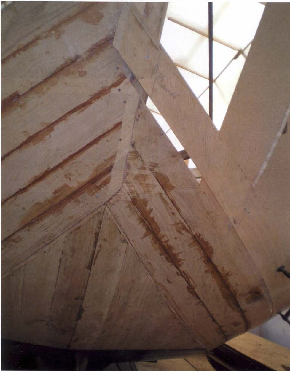
boven: De derde laag wordt gelijmd, nu volgt het berghout (onder), ook de gelamineerde zwaardklampen zijn al aangebracht
