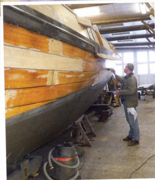
boven: Stuurboord voor was slecht en had nieuwe gangen nodig. Hier zijn (vlnr) Henk, Marco en Henry bezig met de eerste van een reeks van zes
