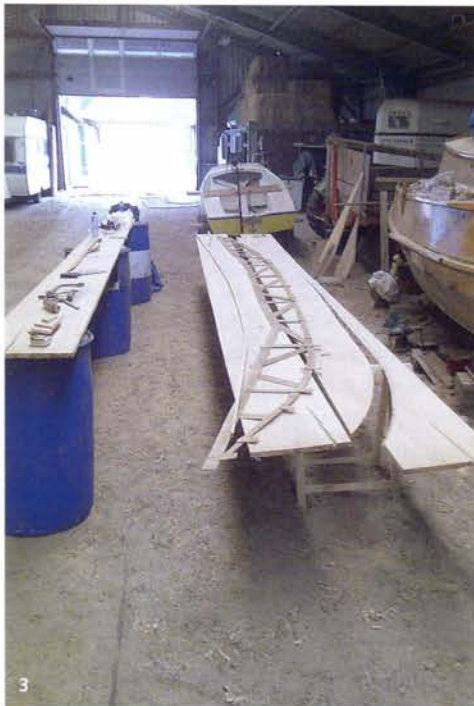
1 Na aanschaf was meteen duidelijk dat er het nodige moest gebeuren wilde Gerben ooit zeilen; eerst sloopte hij het oude rotte vlak weg, dat ligt hier op een kar • 2 De kajuitschouw in de manege. De rotte kimmén heeft Gerben provisorisch opgelapt met stukjes hier en daar • 3 Mal en nieuwe vlakgang in wording • 4 Het vlak aan stuurboord geplaatst. Hij wist de gangen te buigen met behulp van een behangstomer en een dommekracht • 5 Gerben bestelde een stam eiken die gezaagd arriveerde. Hij haalde er leggers (zoals hier op de foto) en spanten uit.
