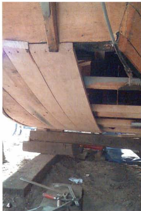
1 Na aanschaf was meteen duidelijk dat er het nodige moest gebeuren wilde Gerben ooit zeilen; eerst sloopte hij het oude rotte vlak weg, dat ligt hier op een kar • 2 De kajuitschouw in de manege. De rotte kimmén heeft Gerben provisorisch opgelapt met stukjes hier en daar • 3 Mal en nieuwe vlakgang in wording • 4 Het vlak aan stuurboord geplaatst. Hij wist de gangen te buigen met behulp van een behangstomer en een dommekracht • 5 Gerben bestelde een stam eiken die gezaagd arriveerde. Hij haalde er leggers (zoals hier op de foto) en spanten uit.
