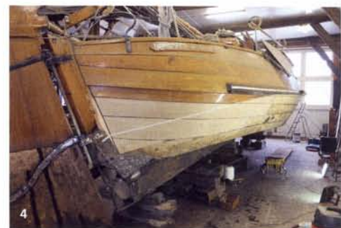
1 De warme en buigbare gang komt vers uit de stoombak en wordt hier met behulp van dommekrachten en balken tegen het schip in de juiste vorm gedrukt. 2 De lijmklemmen moeten de gangen op hun plaats houden zodat ze stijver kunnen worden en hun vorm behouden. 3 Finetunen door Henry van de Wal. 4 Het uiteindelijke resultaat na veel passen, meten en schaven; nieuwe gangen stuurboord achter.
