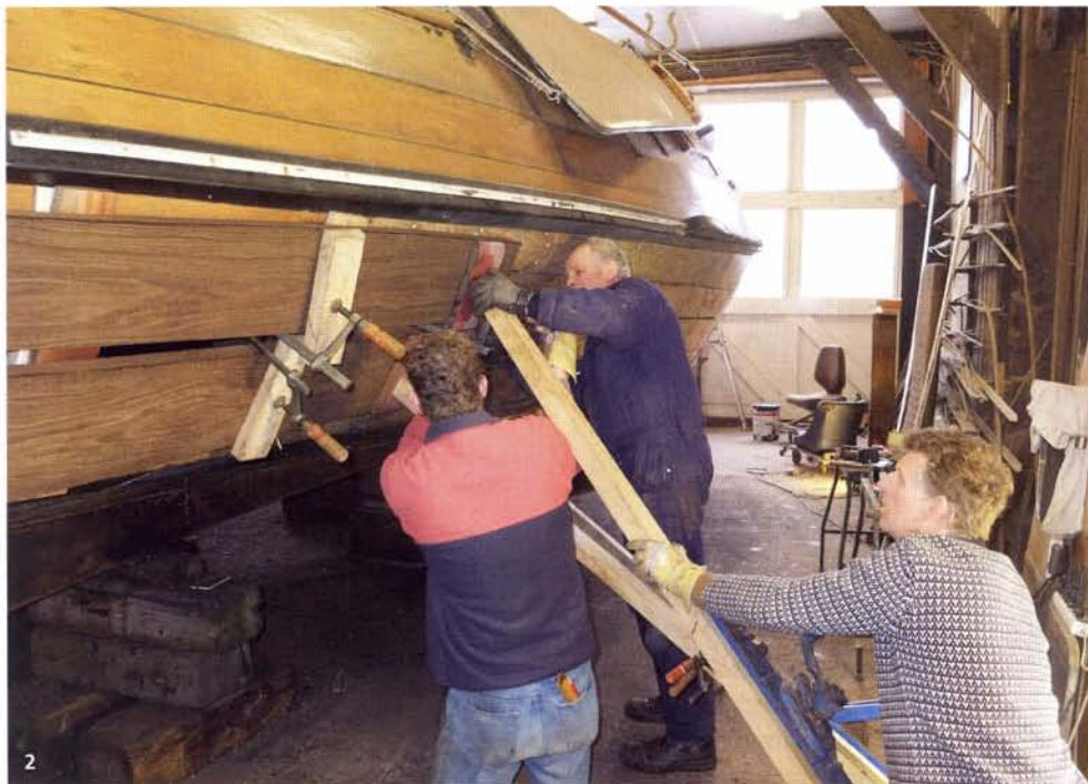
1 De warme en buigbare gang komt vers uit de stoombak en wordt hier met behulp van dommekrachten en balken tegen het schip in de juiste vorm gedrukt. 2 De lijmklemmen moeten de gangen op hun plaats houden zodat ze stijver kunnen worden en hun vorm behouden. 3 Finetunen door Henry van de Wal. 4 Het uiteindelijke resultaat na veel passen, meten en schaven; nieuwe gangen stuurboord achter.
