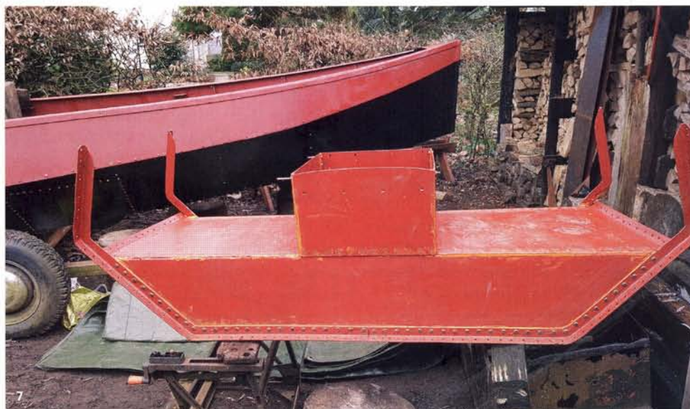
1 Zo trof Arie van der Ree de STR 6 aan • 2 Bart Broere zag er wel brood in en werkte als nieuwe eigenaar al die jaren mee aan de restauratie. Bij zo'n restauratie kom je toch telkens voor verrassingen te staan • 3 Nadat de bun was verwijderd was er niet veel over van bodemplaat en zijwand • 4 De bun staat nu los van de oude plek • 5 In de huid werd een nieuwe plaat gelast. Het vlak werd bijna helemaal vernieuwd • 6 Vele huidplaten werden losgehaald en konden als mal dienen voor een vervangende plaat • 7 De nieuwe, droge, bun werd helemaal nieuw gemaakt en geklonken. Daarna kon hij aan de boot worden geklonken
