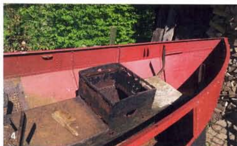
1 Zo trof Arie van der Ree de STR 6 aan • 2 Bart Broere zag er wel brood in en werkte als nieuwe eigenaar al die jaren mee aan de restauratie. Bij zo'n restauratie kom je toch telkens voor verrassingen te staan • 3 Nadat de bun was verwijderd was er niet veel over van bodemplaat en zijwand • 4 De bun staat nu los van de oude plek • 5 In de huid werd een nieuwe plaat gelast. Het vlak werd bijna helemaal vernieuwd • 6 Vele huidplaten werden losgehaald en konden als mal dienen voor een vervangende plaat • 7 De nieuwe, droge, bun werd helemaal nieuw gemaakt en geklonken. Daarna kon hij aan de boot worden geklonken
