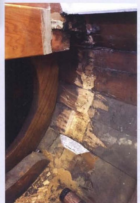
rechts: Witrot achter een spant. Nadat het spant is verwijderd is de schimmel duidelijk zichtbaar. (Foto's Martijn Perdijk)
