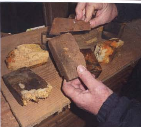
boven: Wim Mendelts laat wat stukjes door schimmel aangetast hout zien. Je kunt het verpulveren tussen je vingers. (Foto Wim de Bruijn)
