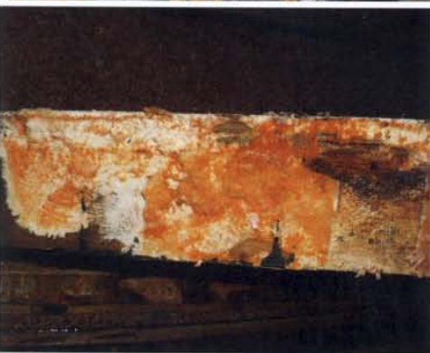
boven: Aan de vochtplekken onder de lak van het potdeksel zie je al dat je niet veel goeds kunt verwachten
