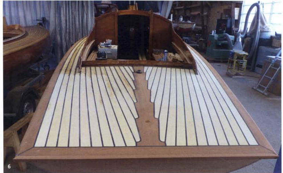
1 Op deze nieuwgebouwde 16 m 2 is het lijfhout, bestaande uit twee teakdeeltjes, met epoxy tegen de stootrand en op het hechthouten dek gelijmd • 2 Alle dekdeeltjes zijn verlijmd met epoxy aan het onderdek van multiplex, terwijl de naden zijn vrijgehouden • 3 Nadat de naden zijn voorzien van primer, worden ze van onderen af gevuld met dekrubber • 4 Alle naden zijn ruim gevuld met dekrubber. Daarna wordt het overtollige rubber weggesneden en kan alles worden geschuurd. Als er nog een luchtbel in het rubber wordt gevonden, werk die dan bij • 5 Het resultaat na het schuren heeft een oogverblindend effect, waar je als amateur erg blij van wordt. Let ook op de vertanding in het vissingstuk • 6 Een dek kan ook heel goed van Yellow Cedar latten worden gemaakt. Het lichte hout geeft een fraai effect naast de donkere lijfhouten en vissingstuk
