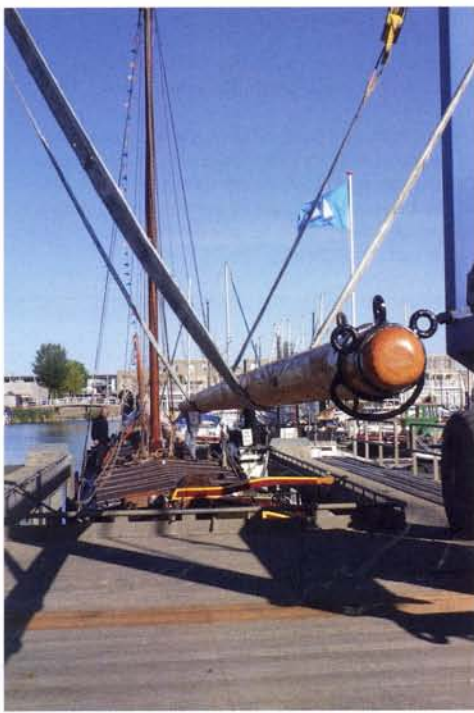
boven:Foto van de nieuwe giek met het gemonteerde beslag die vorig jaar september werd geplaatst
