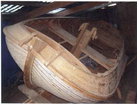
links boven: Om het breeuwen makkelijker uit te kunnen voeren is de romp gekanteld
