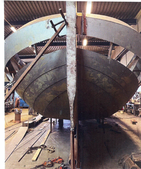
boven links: Het 14,75 m casco is bijna dicht op de sluitgang aan bakboord na
